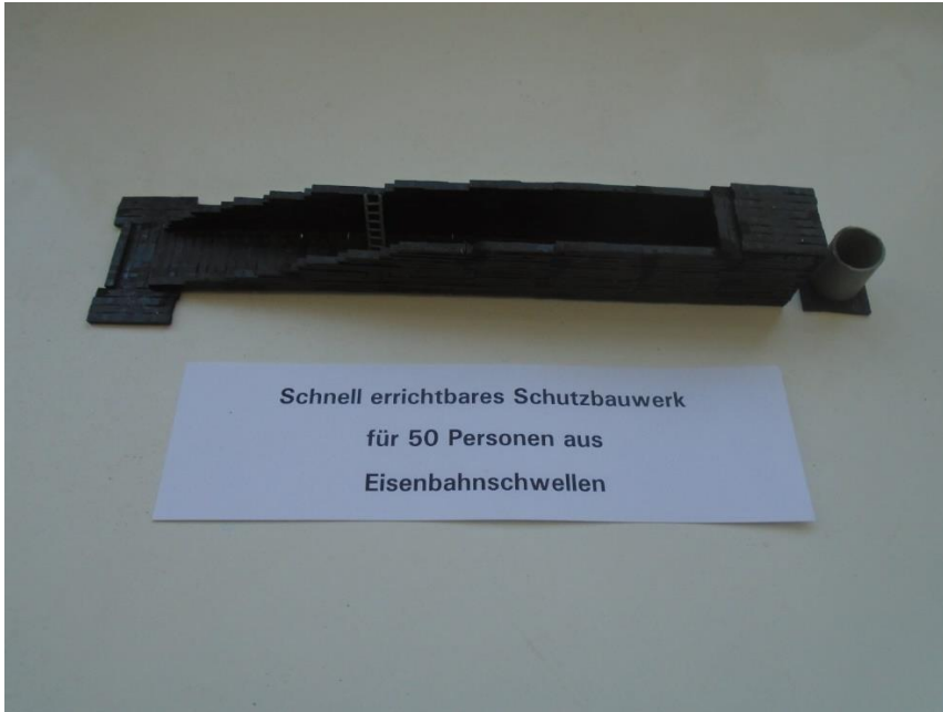
Abb. 15: Es muss nicht immer Beton sein. Auch Bahnschwellen als Baumaterial wären möglich gewesen. Eingebaut in die Erde und Überschüttet wäre das Ziel erreicht worden: Strahlenschutz für einige Tage.
