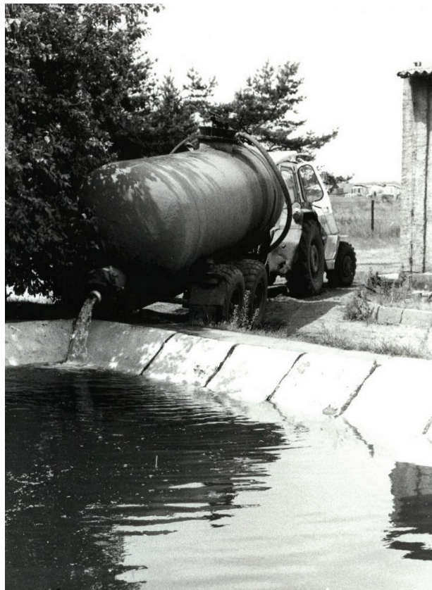
Abb. 6: Hier ist ein Güllewagen HTS 100 einer frühen Bauform zu erkennen. Mit ihm wird der Löschteich gerade gefüllt. Der HTS 100 verfügte über eine Vakuum-Pumpe und konnte sich so selbst betanken.
