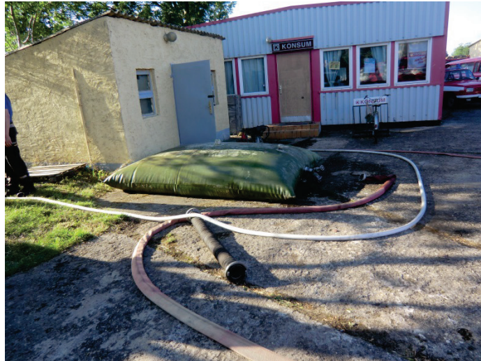
Abb. 1: Wasserblase 3000 Liter; heute im Besitz des Blaulichtmuseums Beuster. Eine solche Wasserblase wurde auf den LKW S4000 oder W 50 aufgesetzt.
