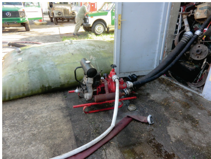
Abb. 2: Die Tragkraftspritze 4 (Leistung 400 Liter in der Minute) ist noch voll funktionsfähig. Sie wurde auf die Pritsche des Behelfstanklöschfahrzeuges gestellt.
