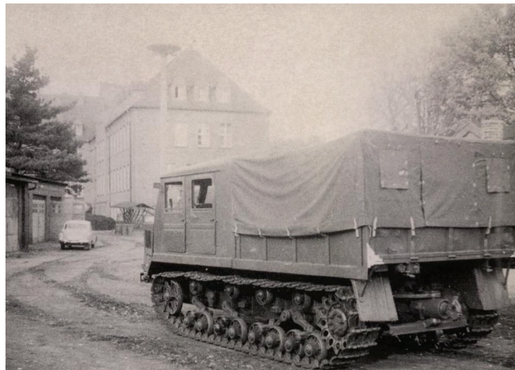
Abb. 2: Kettenzugmaschine AT-S mit Plane. Bei der NVA wurden diese Fahrzeuge zum Ziehen von Artilleriegeschützen eingesetzt
