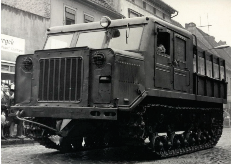
Abb. 3: Die AT-S wirkt aus dieser Perspektive noch wuchtiger. Der Tarnscheinwerfer und die Scheinwerferkappen sind deutliche Indizien für die Herkunft aus den Beständen der NVA.
